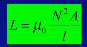
For N=100, 1=5 cm, A=0.3 cm<sup>2</sup>, L= $4\pi$  x10<sup>-7</sup>x100<sup>2</sup>x0.3x10<sup>-4</sup>/0.05=7.5  $\mu$ H.
