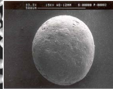
0.6 – 0.8 mm \text{Li}_2\text{TiO}_3 pebbles (CEA)
