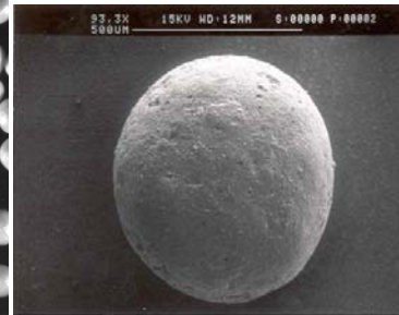
0.6 – 0.8 mm \text{Li}_2\text{TiO}_3 pebbles (CEA)
