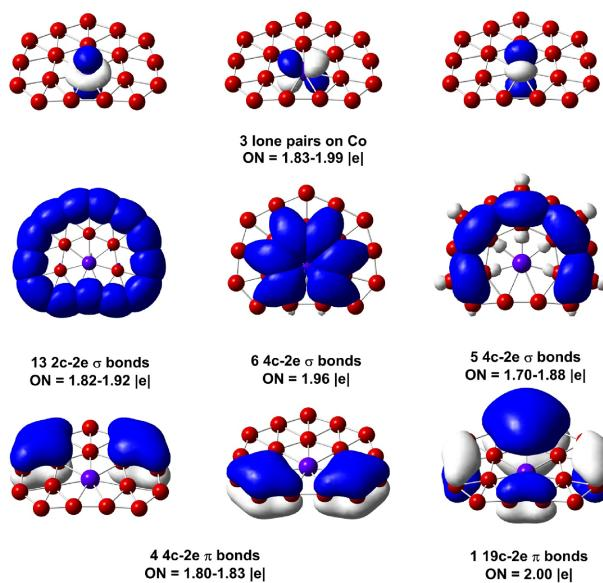
图 5  $\text{CoB}_{18}^-$ 的AdNDP电子结构分析<sup>[77]</sup> (网络版彩图)
