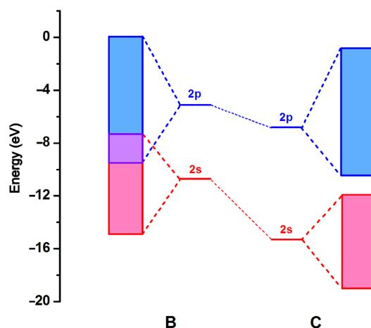
图3 硼和碳原子2s、2p轨道能级及其团簇能带示意图(基于PBE/TZ2P方法B和C中性原子中的2p-2s轨道能量差分别为5.6和8.5 eV) (网络版彩图)
