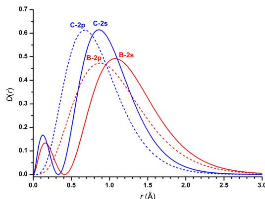
图2 硼和碳原子2s、2p轨道径向密度分布函数( $D(r)=r^2 \cdot R^2$ ) (网络版彩图)
