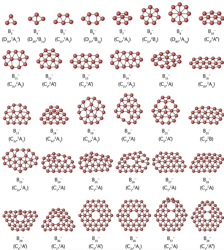
图 4  $B_n^-$  ( $n=3\sim 30, 35\sim 38$ ) 的稳定结构及对称性(图中所示为最稳定的平面结构, 其中  $B_{28}^-$  和  $B_{29}^-$  团簇中立体结构与平面结构共存)<sup>[6]</sup> (网络版彩图)
