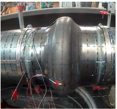
(d) +1.15 in. (30 mm) axial displacement
