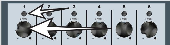
10. Réglez ainsi toutes les voies. Utilisez le bouton de niveau de voie pour régler le niveau de la voie dans le mixage général, puis utilisez le bouton de niveau général de sortie. Le bouton de sortie générale du Passport est équipé d'afficheurs de niveaux. S'ils passent dans la zone rouge, réduisez le niveau de sortie générale.
