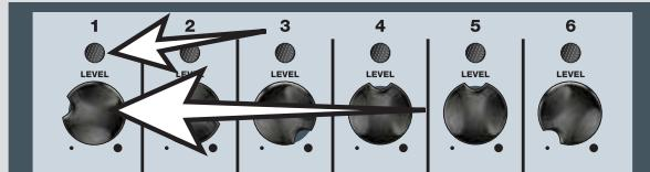
10. Configure cada um dos outros canais da mesma forma. Use os botões de canal Level para ajustar a altura relativa de cada canal até que você consiga o equilíbrio geral apropriado, e, então, use o botão master de Volume para ajustar tudo junto. O botão master de Volume no seu Passport tem medidores de sinal de nível. Caso veja os medidores acesos na zona vermelha, diminua o botão master de Volume.
