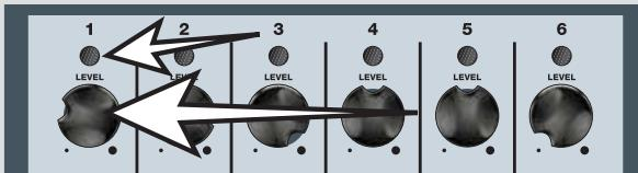
10. 他のチャンネルも同じ方法で設定してください。相対的な音量を調節するには、全体的なバランスが取れるまで、チャンネルのレベルノブを使用します。その後マスター Volume ノブを使ってすべてと一緒に調節します。Passport のマスター Volume ノブは信号レベルメーターを備えています。メーターが赤のゾーンまで点灯するのを確認した場合は、マスター Volume ノブを下げてください。
