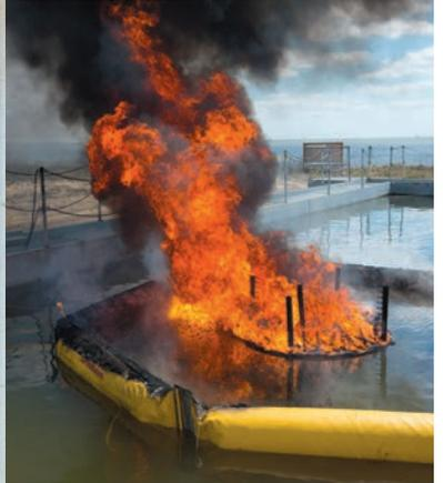
ARSAVA AND BORTH PLACE THE FLAME REFLEXER IN THE TEST STAND SURROUNDED BY A FIRE BOOM CHARRED FROM AN EARLIER TEST. THE INTENSE FIRE AND GRAY SMOKE (RISING TOWARD THE EMISSIONS COLLECTION SYSTEM, WITH ITS ORANGE WINDSOCK) ARE TESTAMENTS TO THE REFLEXER'S EFFECTIVENESS.
